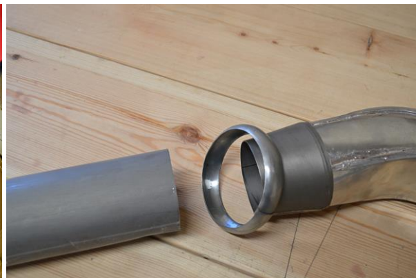
Lage vuls i maskin (t.v.), og ferdig vuls for lodding på overgangen fra firkantrør til rundt rør (t.h.).
