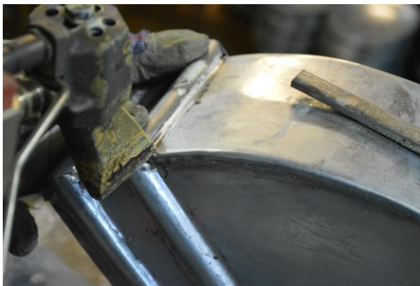
Andre kopibyg, svanehalsnedløp med ornamentering og fals. Laging av fals med godt mothold.
