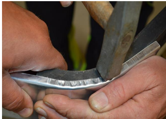
Andre kopibyg, svanehalsnedløp med ornamentering og fals. Laging av fals med godt mothold.
