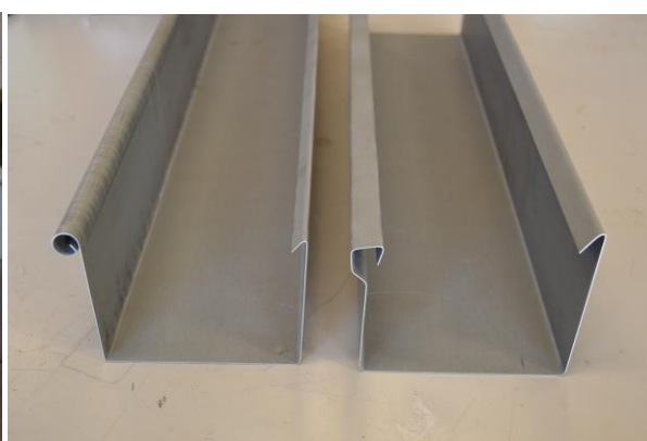
Første kopibyget av renne og nedløp (t.v.), og renne med vuls utover og fals innover (t.h.).
