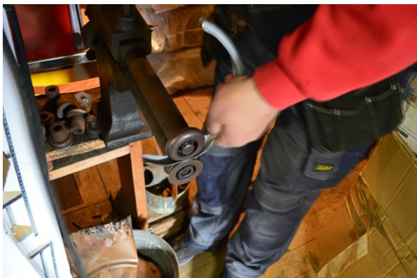
Lage vuls i maskin (t.v.), og ferdig vuls for lodding på overgangen fra firkantrør til rundt rør (t.h.).
