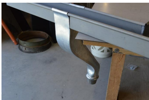
Første kopibyget av renne og nedløp (t.v.), og renne med vuls utover og fals innover (t.h.).
