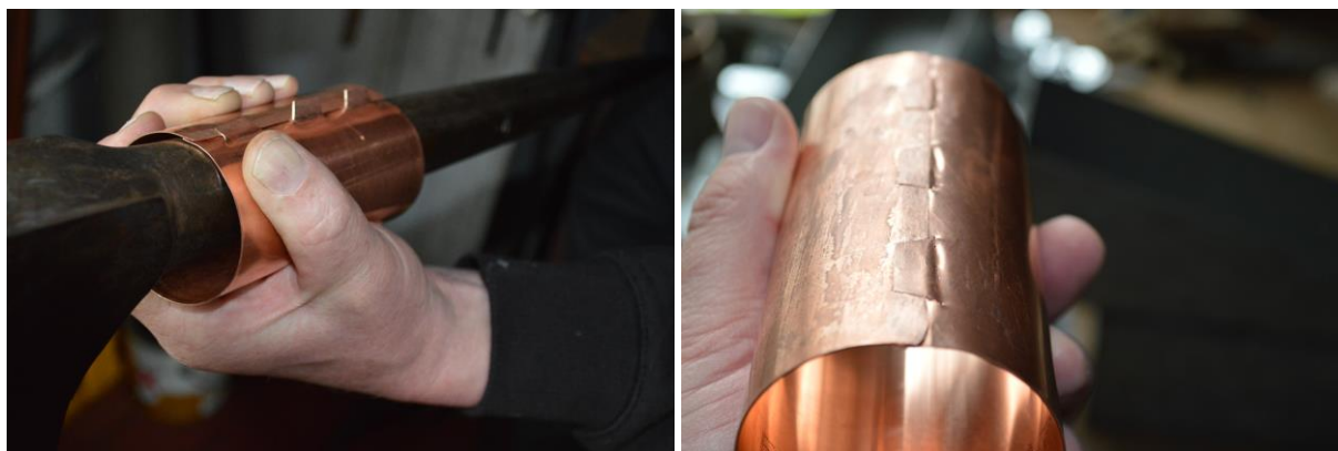
Bildene viser valset kobberrør, lagde fingerskjøter, hakkene som ble hamret tynne og sammenføydd og ferdig rør for lodding.
