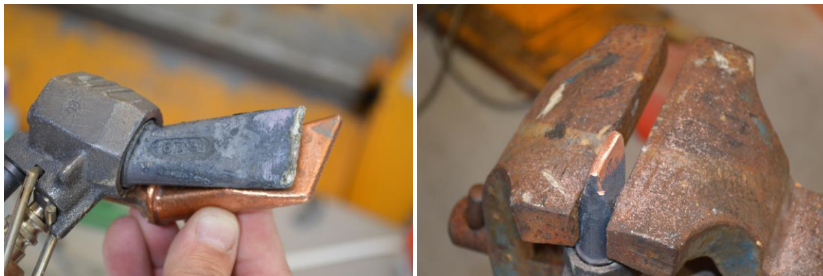
Godt brukt og ny loddebolt, samt restaurering av eldre bolt. Det finnes flere typer, men det var disse vi brukte i prosjektet.
