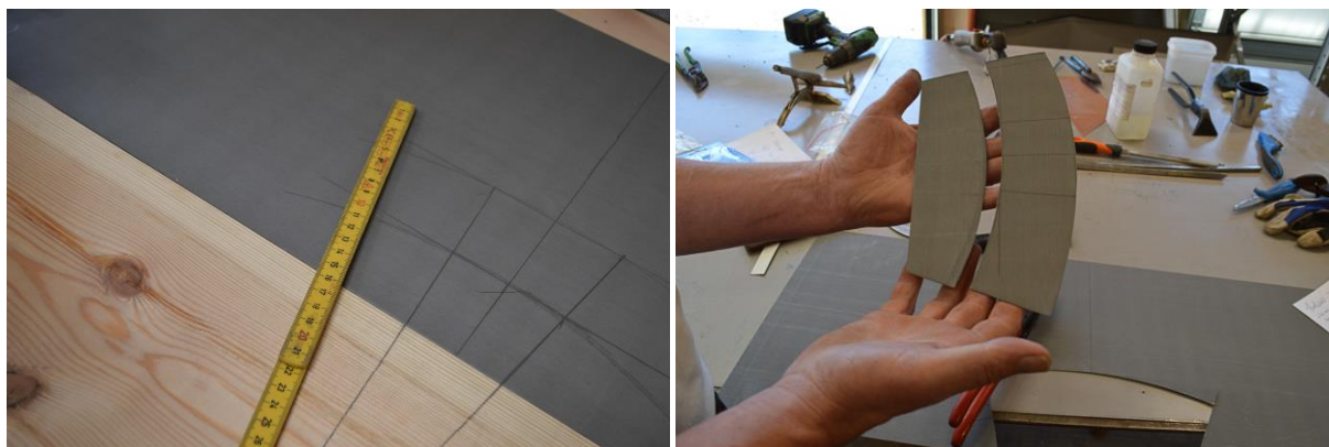
Måltatt tegning som er tilpasset overgangen fra firkantet til rundt rør (t.v.), og overgangen klar til valsing (t.h.).
